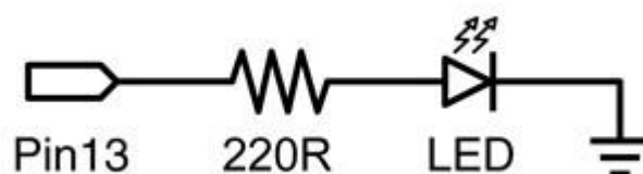
Conexión de un diodo Led a una salida de Arduino
